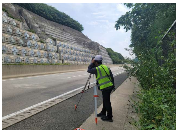
광파기를 이용한 경사도 측정
